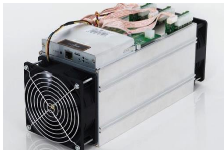
Grafik 18.1: Komputer Antminer S9 yang digunakan khusus untuk mining Bitcoin
